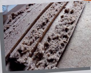
ウッドファイバーという木の繊維でできた断熱材を使用しています。従来のグラスウール（ガラスを綿状にしたもの）に比べて人体に影響がないのはもちろん、木というと燃えやすそうなイメージがあるが表面が炭化することで発火温度が上がり実は燃えにくく、風を通し熱は逃がさないという優れもの。日本では苦小牧にしか工場がなく広く浸透してはいないものの、環境先進国ドイツでは主流の断熱材になっているそう。
